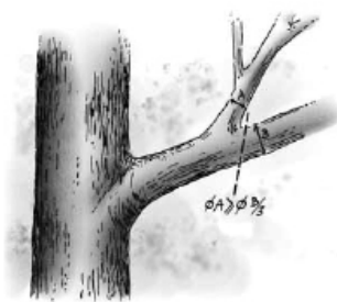
Skica 11: Premer veje, ki ostane mora predstavljati vsaj 1/3 premera veje, ki se bo odstranila.
