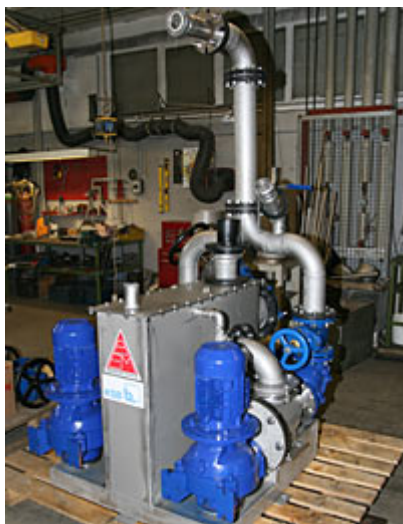
Slika 1. Becker Elektomaschinenbau GmbH; Trockenaufstellung - Sperrstoff-Trennsystem
